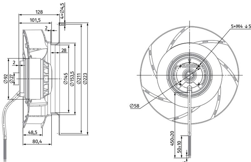
RADIALE AC-VENTILATOREN MIT RÜCKWÄRTS GEKRÜMMTEN SCHAUFELN
