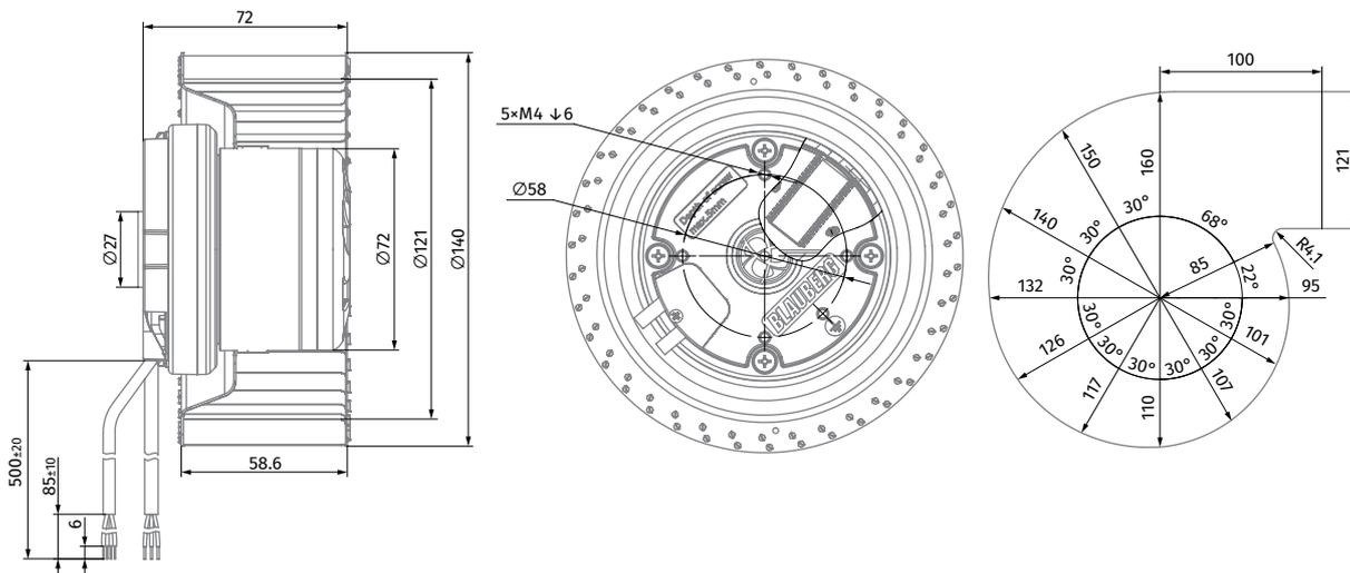
RADIALE AC-VENTILATOREN MIT RÜCKWÄRTS GEKRÜMMTEN SCHAUFELN
