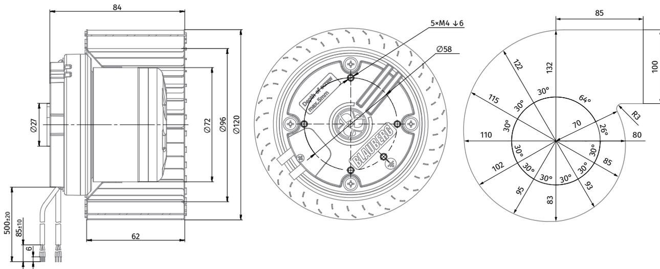
RADIALE AC-VENTILATOREN MIT RÜCKWÄRTS GEKRÜMMTEN SCHAUFELN
