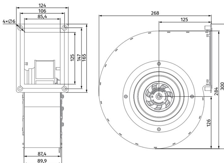
RADIALE AC-VENTILATOREN MIT RÜCKWÄRTS GEKRÜMMTEN SCHAUFELN
