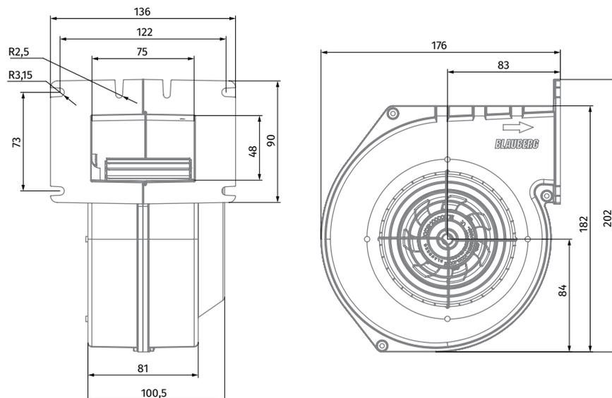
RADIALE AC-VENTILATOREN MIT RÜCKWÄRTS GEBÜGELTEN SCHAUFELN
