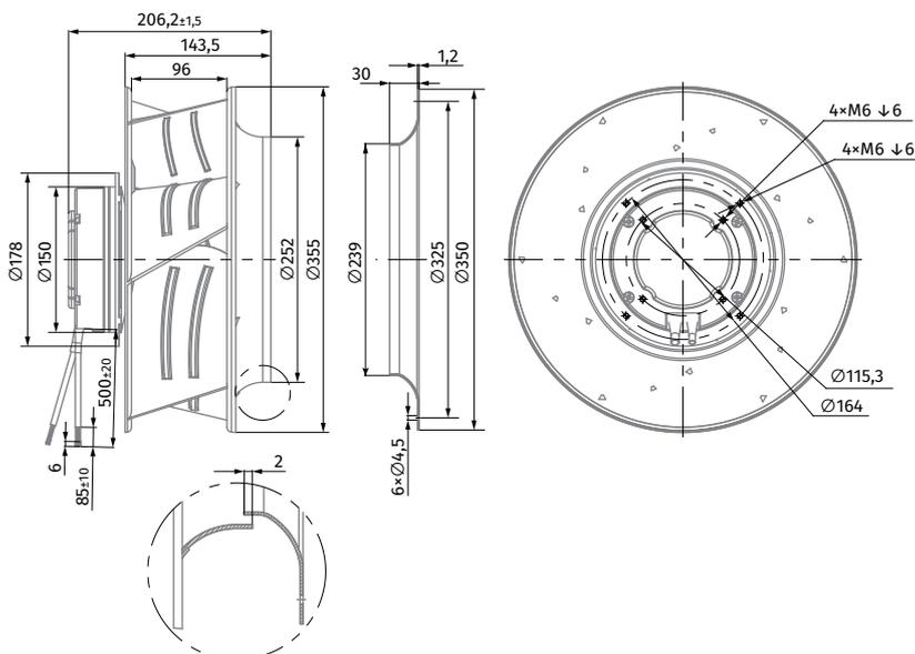
RADIALE AC-VENTILATOREN MIT RÜCKWÄRTS GEKRÜMMTEN SCHAUFELN
