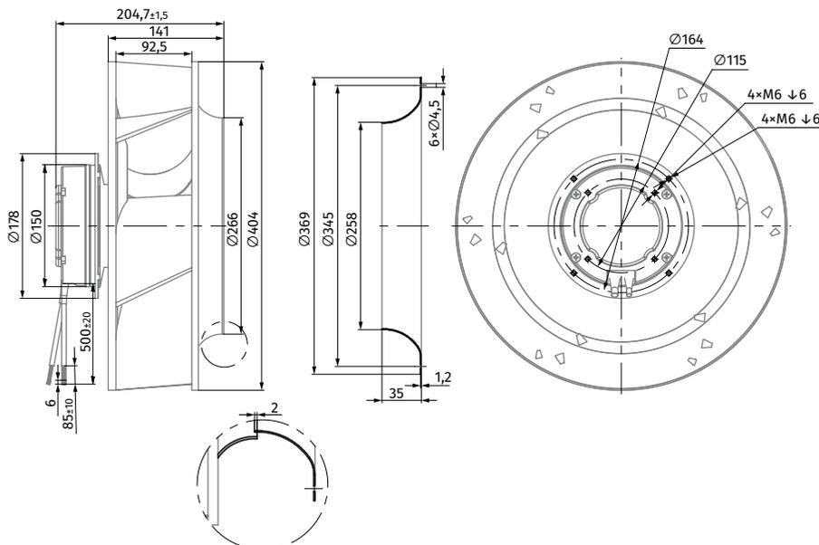
RADIALE AC-VENTILATOREN MIT RÜCKWÄRTS GEKRÜMMTEN SCHAUFELN
