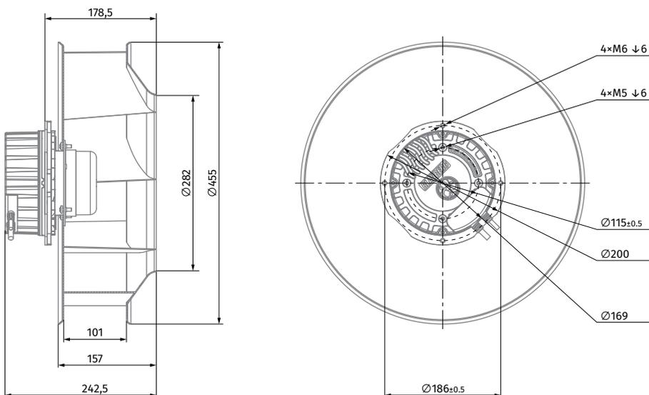
RADIALE AC-VENTILATOREN MIT RÜCKWÄRTS GEKRÜMMTEN SCHAUFELN
