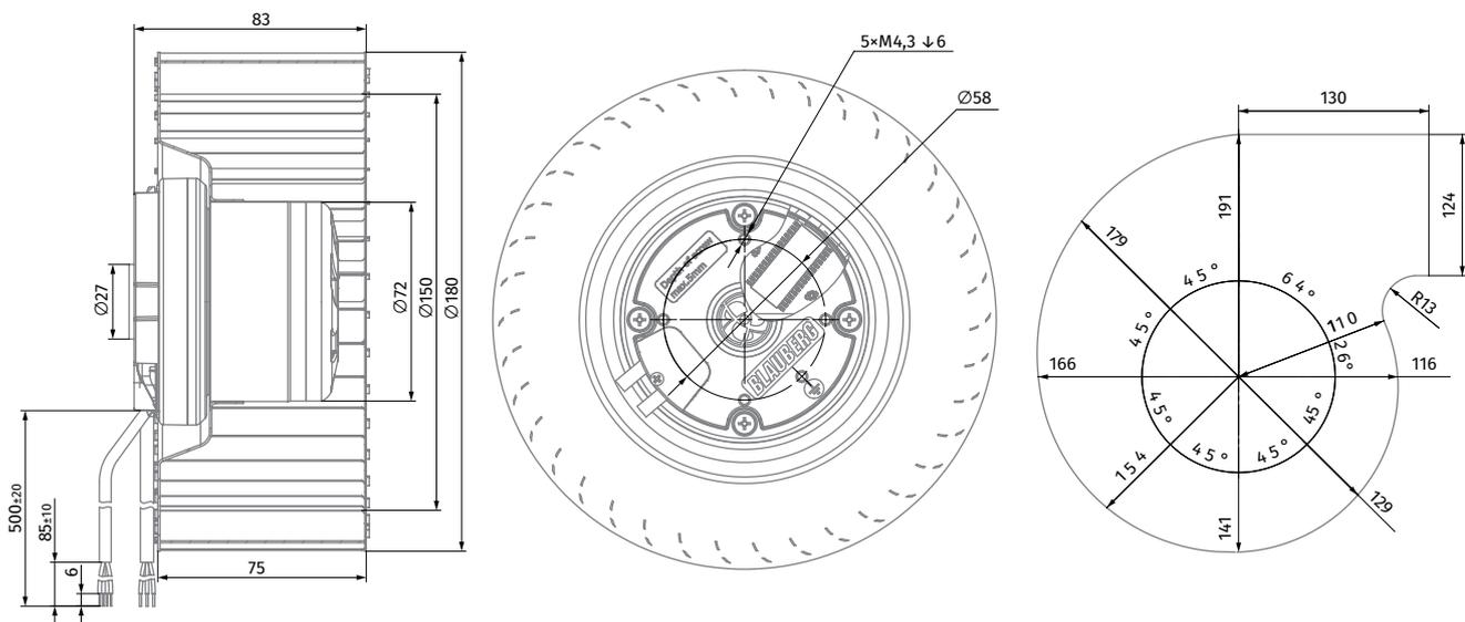
RADIALE AC-VENTILATOREN MIT RÜCKWÄRTS GEKRÜMMTEN SCHAUFELN
