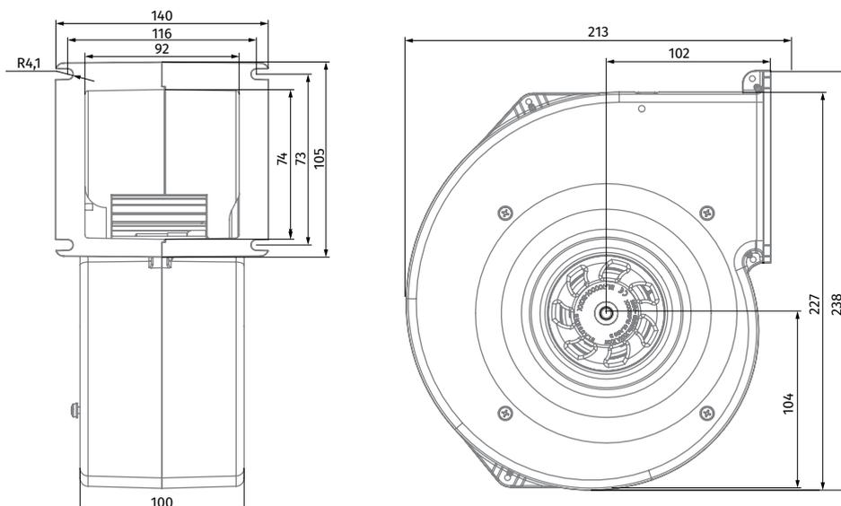
RADIALE AC-VENTILATOREN MIT RÜCKWÄRTS GEBÜGELTEN SCHAUFELN
