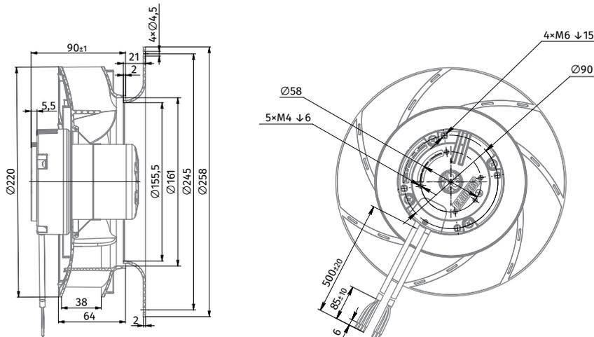
RADIALE AC-VENTILATOREN MIT RÜCKWÄRTS GEKRÜMMTEN SCHAUFELN
