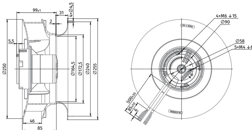
RADIALE AC-VENTILATOREN MIT RÜCKWÄRTS GEKRÜMMTEN SCHAUFELN
