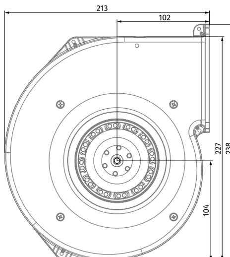
RADIALE AC-VENTILATOREN MIT RÜCKWÄRTS GEBÜGELTEN SCHAUFELN
