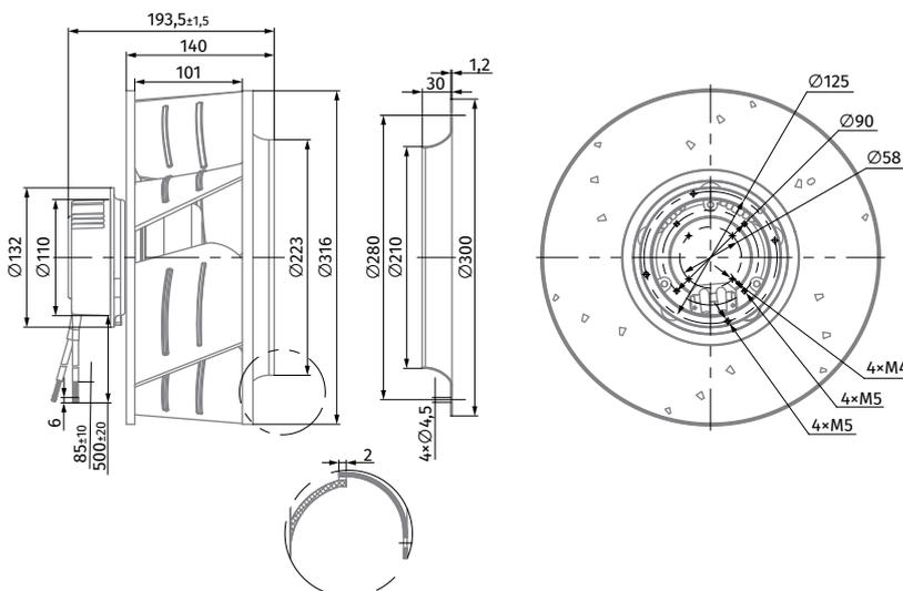
RADIALE AC-VENTILATOREN MIT RÜCKWÄRTS GEKRÜMMTEN SCHAUFELN
