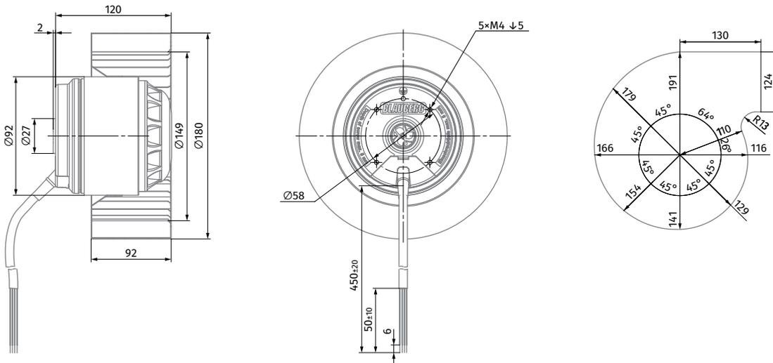
RADIALE AC-VENTILATOREN MIT RÜCKWÄRTS GEKRÜMMTEN SCHAUFELN
