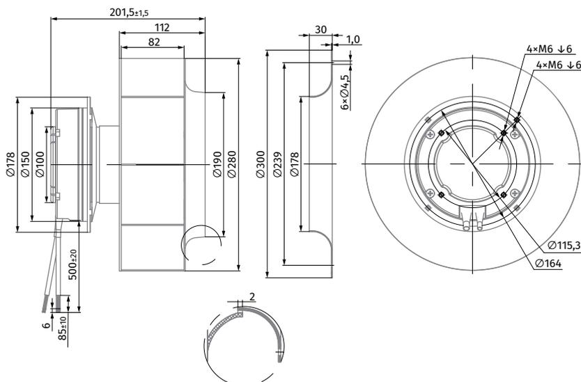
RADIALE AC-VENTILATOREN MIT RÜCKWÄRTS GEKRÜMMTEN SCHAUFELN
