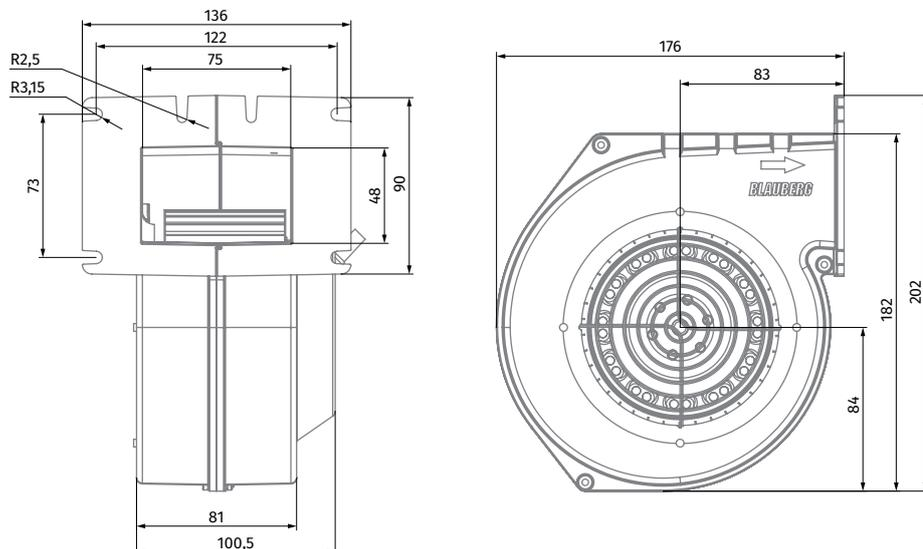
RADIALE AC-VENTILATOREN MIT RÜCKWÄRTS GEBÜGELTEN SCHAUFELN
