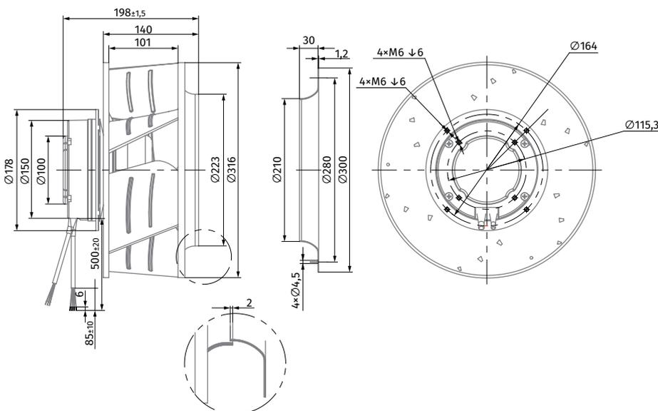
RADIALE AC-VENTILATOREN MIT RÜCKWÄRTS GEKRÜMMTEN SCHAUFELN
