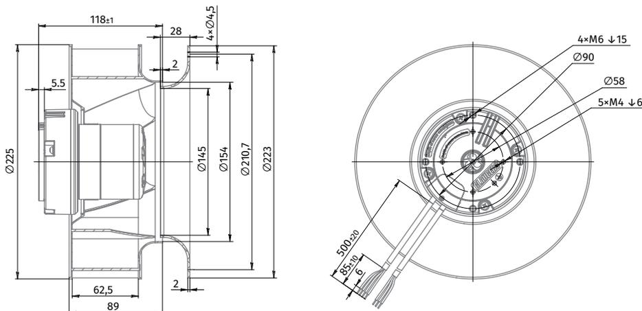
RADIALE AC-VENTILATOREN MIT RÜCKWÄRTS GEKRÜMMTEN SCHAUFELN
