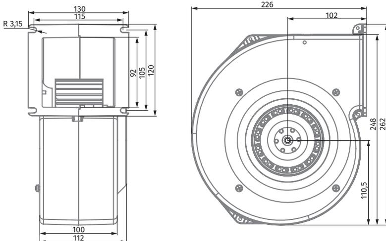
ЦЕНТРОБЕЖНЫЕ ВЕНТИЛЯТОРЫ С АС-ДВИГАТЕЛЕМ И НАЗАД ЗАГНУТЫМИ ЛОПАТКАМИ
