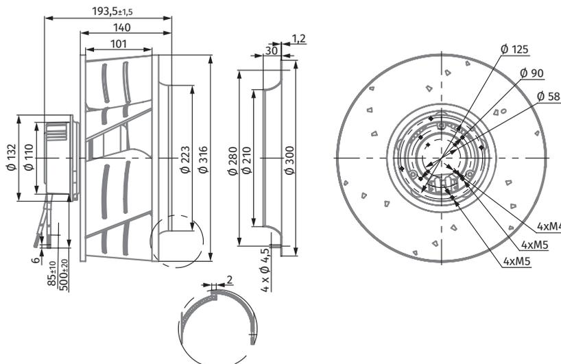
ЦЕНТРОБЕЖНЫЕ ВЕНТИЛЯТОРЫ С АС-ДВИГАТЕЛЯМИ И НАЗАД ЗАГНУТЫМИ ЛОПАТКАМИ
