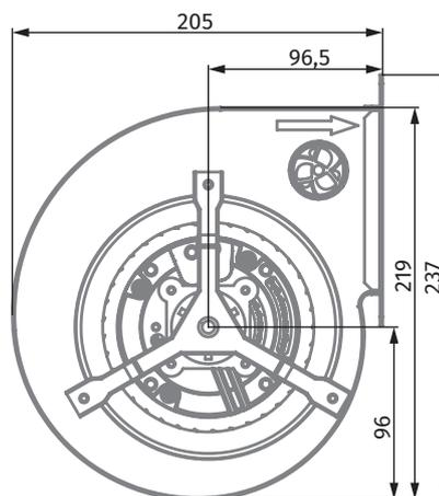
ЦЕНТРОБЕЖНЫЕ ВЕНТИЛЯТОРЫ С АС-ДВИГАТЕЛЯМИ И НАЗАД ЗАГНУТЫМИ ЛОПАТКАМИ
