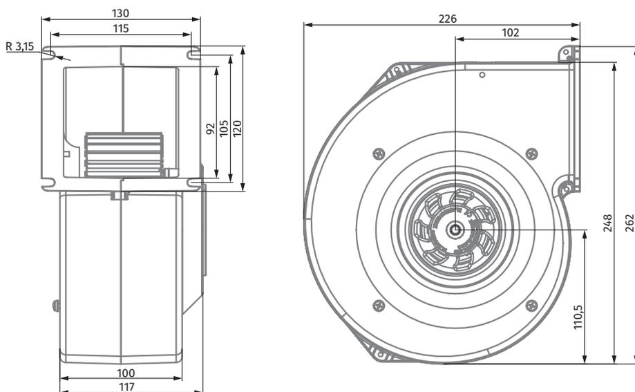
Ø 120 мм, двустороннее всасывание (вперед загнутые лопатки)
