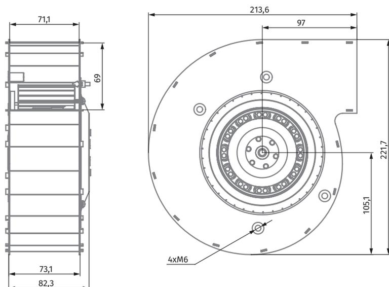
Ø 140 мм, одностороннее всасывание (вперед загнутые лопатки)
