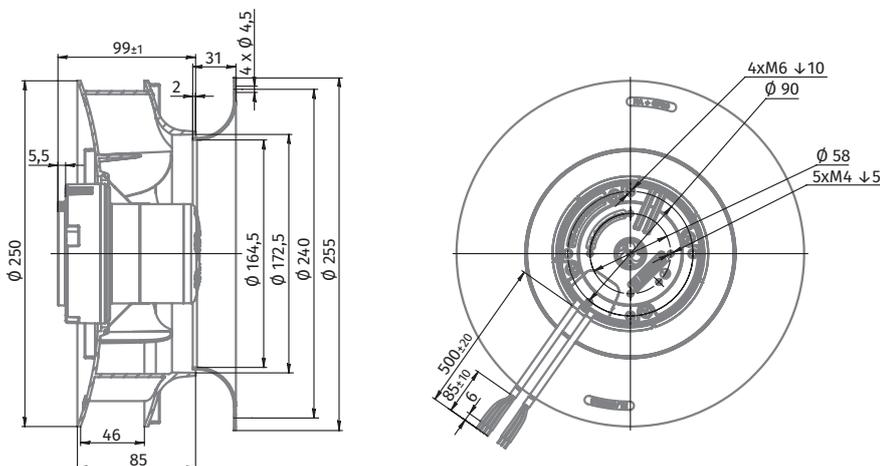
ЦЕНТРОБЕЖНЫЕ ВЕНТИЛЯТОРЫ С АС-ДВИГАТЕЛЯМИ И НАЗАД ЗАГНУТЫМИ ЛОПАТКАМИ
