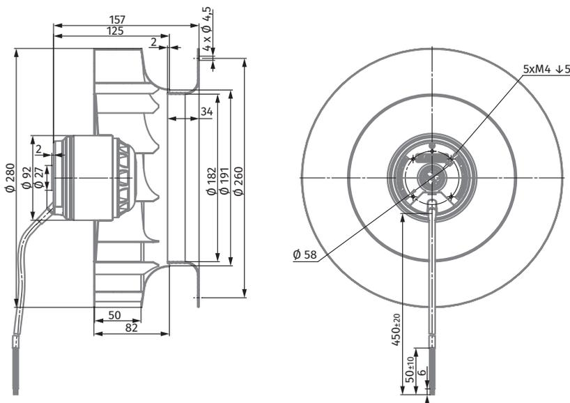
ЦЕНТРОБЕЖНЫЕ ВЕНТИЛЯТОРЫ С АС-ДВИГАТЕЛЕМ И НАЗАД ЗАГНУТЫМИ ЛОПАТКАМИ
