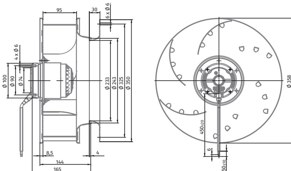
ЦЕНТРОБЕЖНЫЕ ВЕНТИЛЯТОРЫ С АС-ДВИГАТЕЛЯМИ И НАЗАД ЗАГНУТЫМИ ЛОПАТКАМИ
