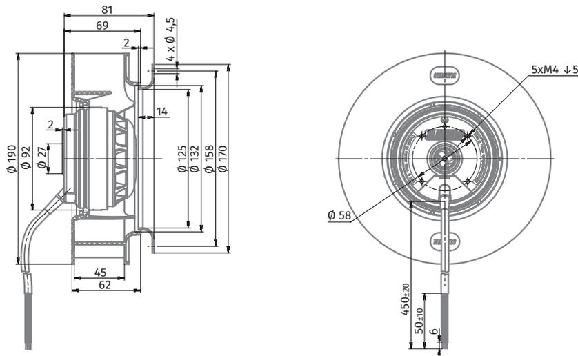
ЦЕНТРОБЕЖНЫЕ ВЕНТИЛЯТОРЫ С АС-ДВИГАТЕЛЕМ И НАЗАД ЗАГНУТЫМИ ЛОПАТКАМИ
