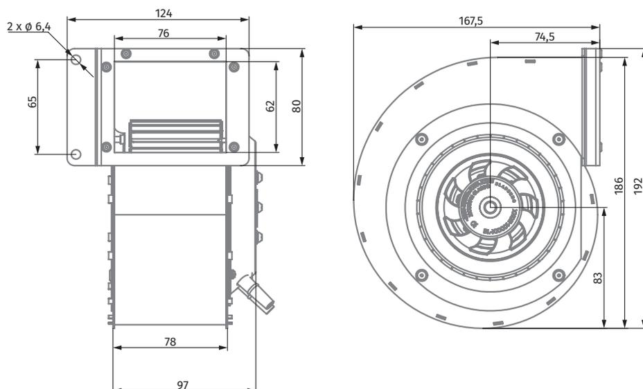
Ø 120 мм, одностороннее всасывание (вперед загнутые лопатки)
