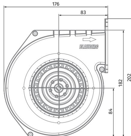
ЦЕНТРОБЕЖНЫЕ ВЕНТИЛЯТОРЫ С АС-ДВИГАТЕЛЯМИ И НАЗАД ЗАГНУТЫМИ ЛОПАТКАМИ
