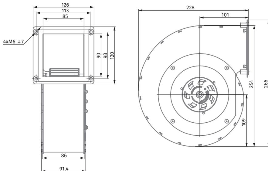
Ø 140 мм, одностороннее всасывание (вперед загнутые лопатки)
