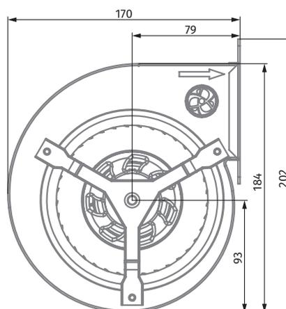
Ø 146 мм, двустороннее всасывание (вперед загнутые лопатки)
