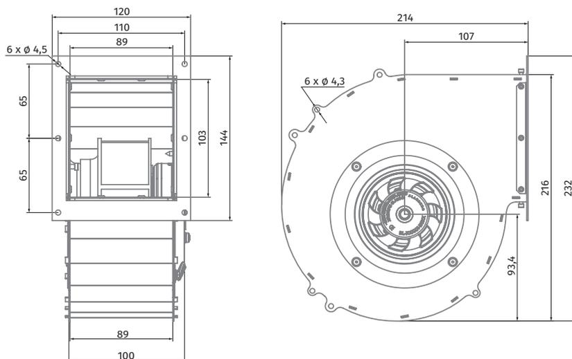
Ø 175 мм, одностороннее всасывание (назад загнутые лопатки)
