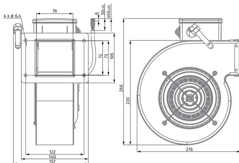
Ø 140 мм, одностороннее всасывание (вперед загнутые лопатки)
