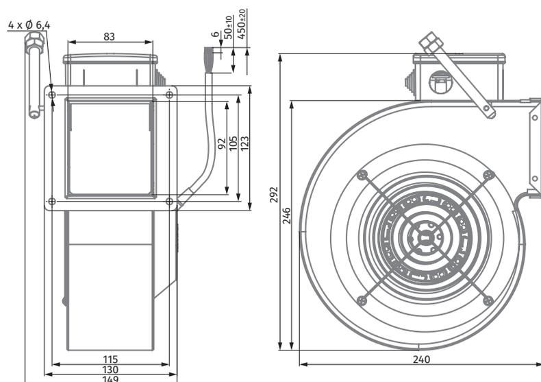
Ø 160 мм, одностороннее всасывание (вперед загнутые лопатки)
