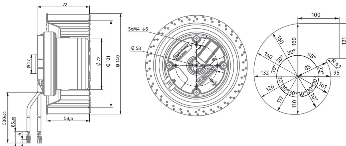
ЦЕНТРОБЕЖНЫЕ ВЕНТИЛЯТОРЫ С АС-ДВИГАТЕЛЯМИ И НАЗАД ЗАГНУТЫМИ ЛОПАТКАМИ
