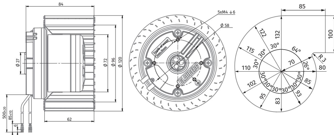
ЦЕНТРОБЕЖНЫЕ ВЕНТИЛЯТОРЫ С АС-ДВИГАТЕЛЯМИ И НАЗАД ЗАГНУТЫМИ ЛОПАТКАМИ
