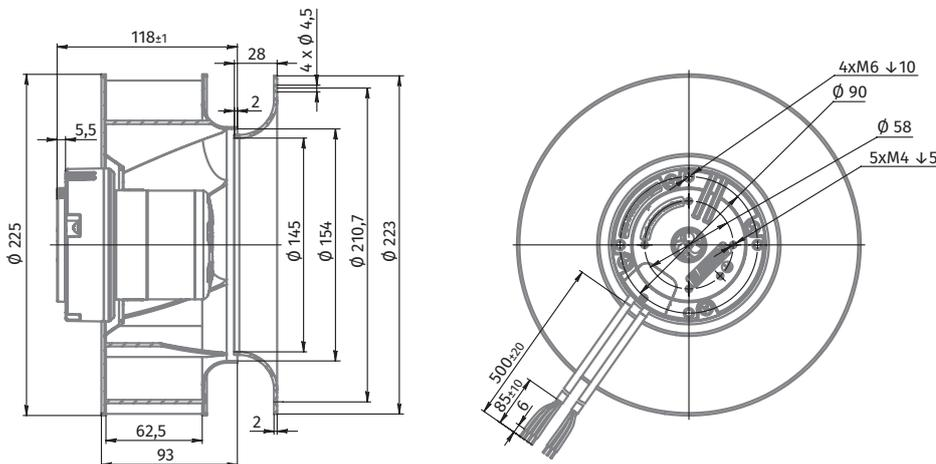
ЦЕНТРОБЕЖНЫЕ ВЕНТИЛЯТОРЫ С АС-ДВИГАТЕЛЯМИ И НАЗАД ЗАГНУТЫМИ ЛОПАТКАМИ
