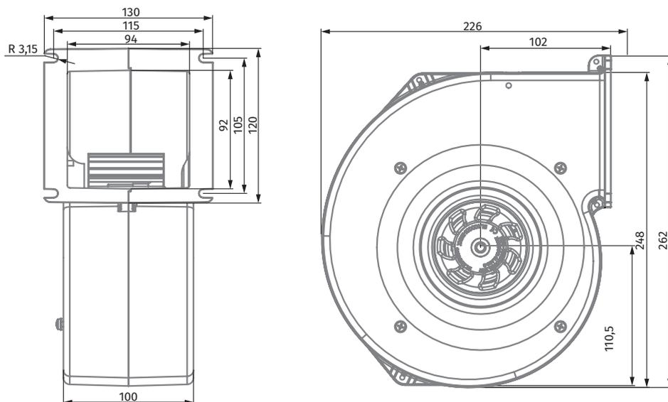
ЦЕНТРОБЕЖНЫЕ ВЕНТИЛЯТОРЫ С АС-ДВИГАТЕЛЯМИ И НАЗАД ЗАГНУТЫМИ ЛОПАТКАМИ
