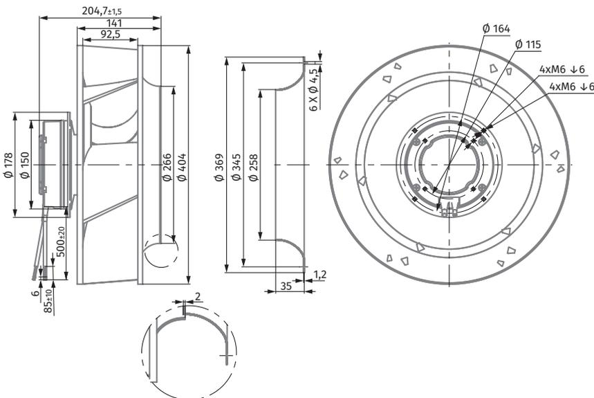
ЦЕНТРОБЕЖНЫЕ ВЕНТИЛЯТОРЫ С АС-ДВИГАТЕЛЯМИ И НАЗАД ЗАГНУТЫМИ ЛОПАТКАМИ
