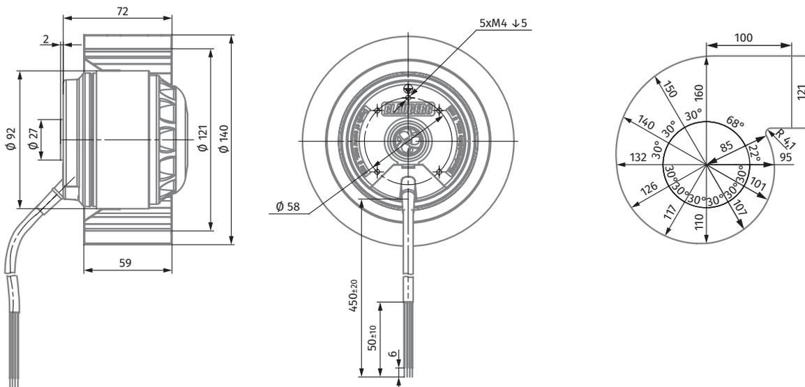
ЦЕНТРОБЕЖНЫЕ ВЕНТИЛЯТОРЫ С АС-ДВИГАТЕЛЯМИ И НАЗАД ЗАГНУТЫМИ ЛОПАТКАМИ
