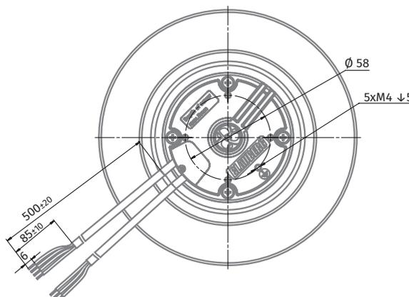
ЦЕНТРОБЕЖНЫЕ ВЕНТИЛЯТОРЫ С АС-ДВИГАТЕЛЯМИ И НАЗАД ЗАГНУТЫМИ ЛОПАТКАМИ
